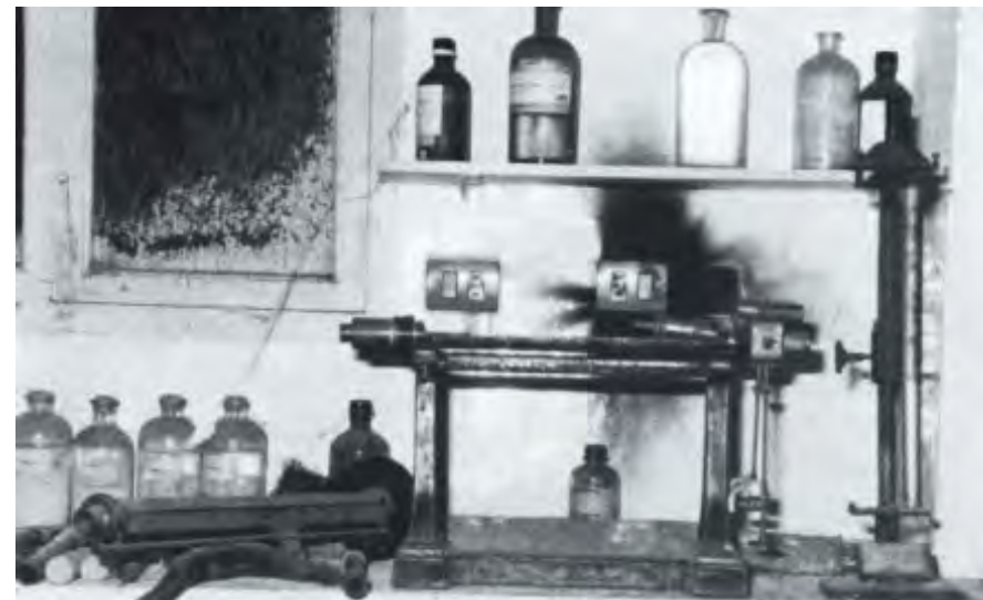
Polarímetros para la determinación de la riqueza sacarina. (De Motril "Zona patrimonial del azúcar". Ayto. de Motril).
