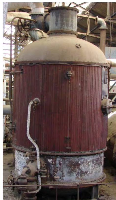
Tachas para la cristalización del azúcar. Estado actual (2013).
