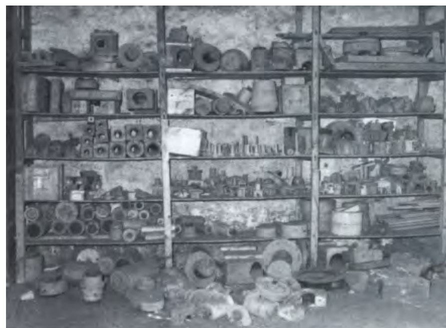
Moldes de fundición para la fabricación de piezas de maquinaria. (De Álbum Fotográfico de Javier Piñar Samos –Miguel Giménez Yanguas).
