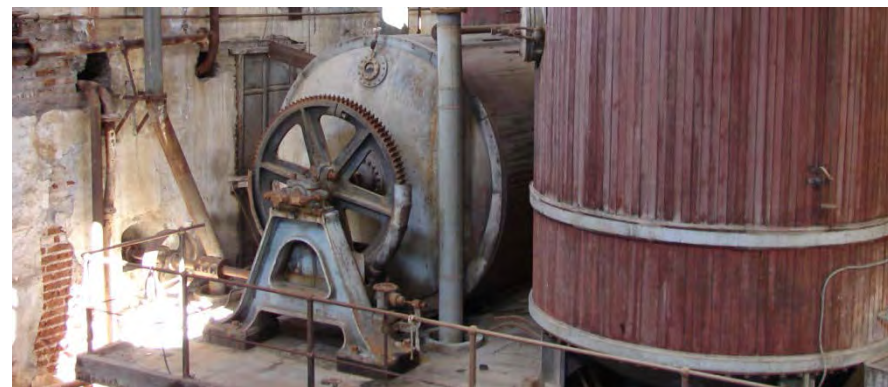
Tachas giratorias para la cristalización del azúcar. Estado actual (2013).
