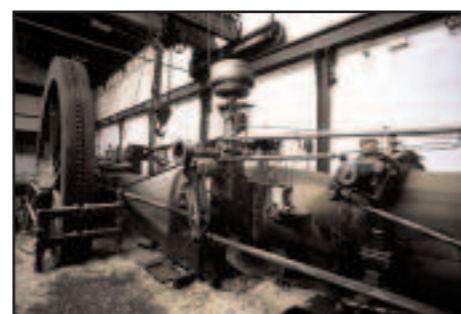
I.8.A.l Fotografía: Máquina de vapor del tren de Molinos (Azucarera del Guadalfeo).
