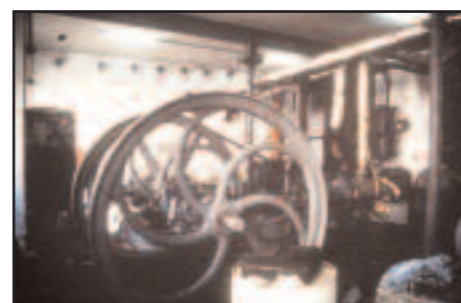
I.8.A.n Fotografía: Fábrica azucarera Ntra. Sra. del Rosario, máquina de vapor CAIL.
